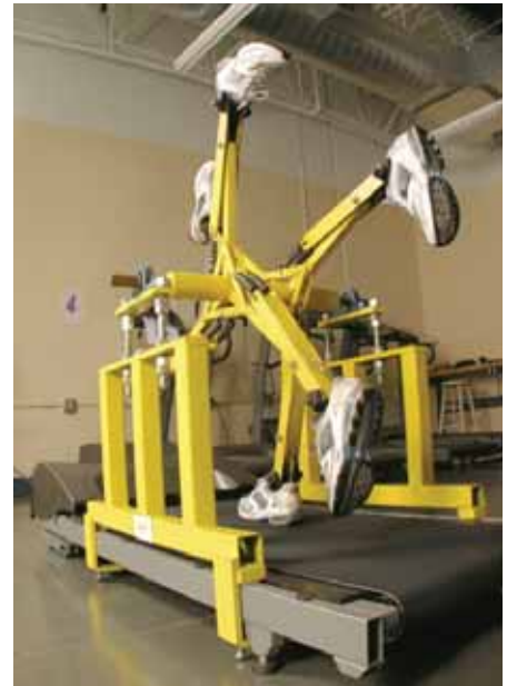
Uno dei tanti strumenti che usiamo per testare la vita del treadmill
